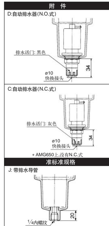
\* AMG850无N.C.式自动排水器及排水导管形式,带排水活门
