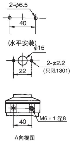
\* IW 系列的安装孔在两侧
