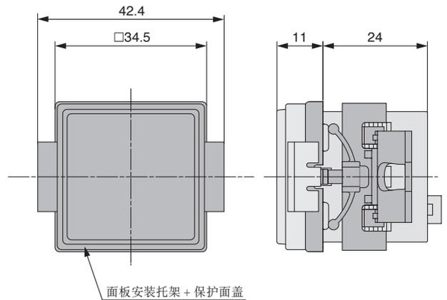
外形尺寸图 (毫米)
