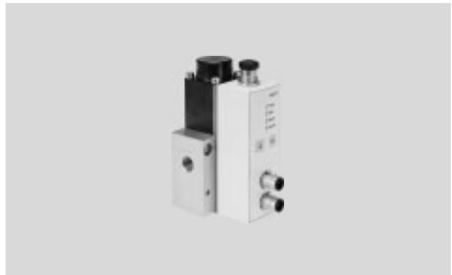
Der Ausgangsdruck des Elektrik-Druckregelventils PREL wird vom Proportional-Druckregelventil VPPL durch einen integrierten Drucksensor ermittelt und intern mit dem Sollwert verglichen. Bei Abweichungen steuert das VPPL solange den Regler des PREL an, bis der Ausgangsdruck den Sollwert erreicht hat. In Grundstellung (keine Sollwertvorgabe) wird
