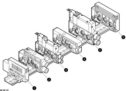
\* 4G1・2 混合集成的注意事项 面对接头,混装模块的左侧是 4G1 系列,右侧是 4G2 系列。 (注意不能反方向进行位置设定。)
