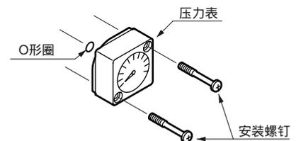
安装螺钉请在0.6N·m以下紧固。
