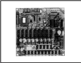
脉冲喷射阀用顺序控制元件
