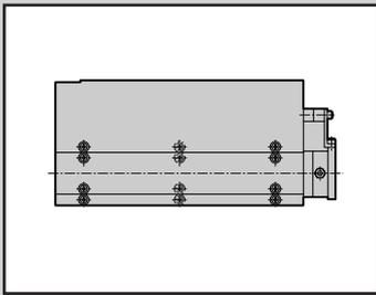
机械手气缸 双作用·带制动器
