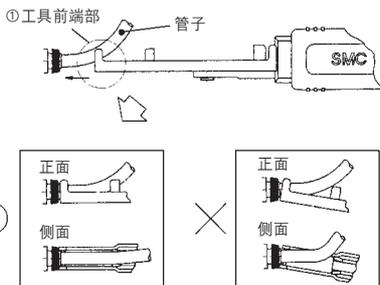
② 插入释放套的前端后，可靠地握住工具的柄，把管子夹持部推到行程末端为止。
