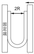
温度20℃的条件下，把管子弯曲成U字形，一端固定，另一端慢慢靠近，管子发生弯折、变扁等时测定的2R。
