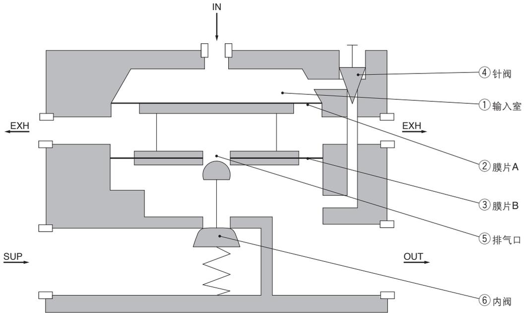
从计测元件来的输入压力进入①输入室并作用于②膜片A，与③膜片B因输出而产生的力对抗。若输入产生的力更大，则⑥内阀被下压，输出侧流出供给空气，反之则⑥内阀关闭⑤排气口打开，进行排气。②膜片A与③膜片B通过此原理不断变换保持平衡。输入侧与输出侧由④针阀连通，该节流阀的调节可使包括增速继电器在内的闭环系统的稳定性更好。
