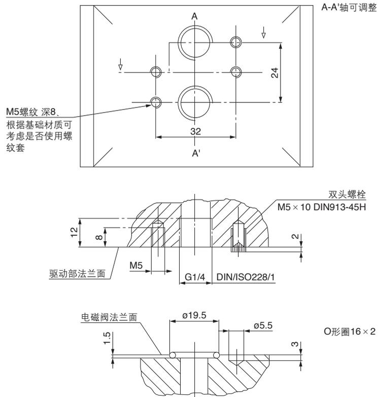
电磁阀可使用2根安装螺钉安装。
