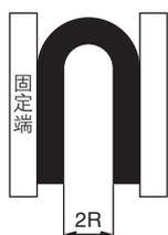
温度20℃的条件下, 让管子弯曲成U字形, 一端固定, 另一端慢慢靠近, 管子发生弯折、变扁等时测定2R。
