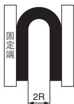
温度20°C的条件下, 让管子弯曲成U字形, 一端固定, 另一端慢慢靠近, 管子发生弯折、变扁等时测定2R。
