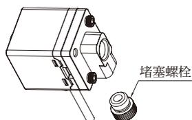
1. 本產品後方有二個入氣孔，安裝壓力導管時請選擇易安裝的入氣孔。
