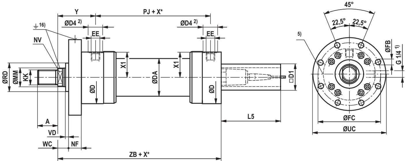
**Abmessungen: Rundflansch am Kopf CSH2...XE: MF3**
