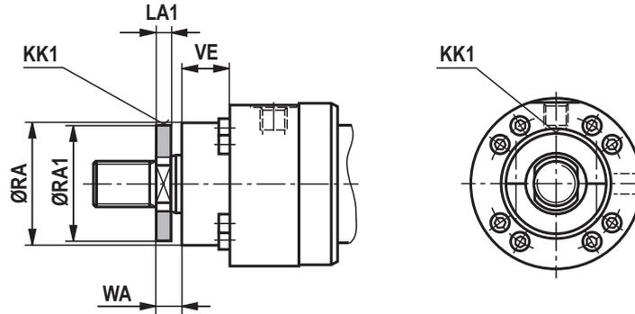
**Potentialausgleich an der Kolbenstange**
