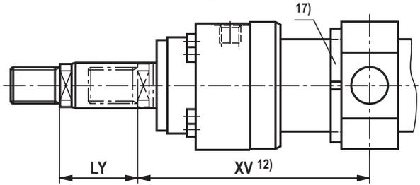
**Maße für Zylinder mit Kolbenstangenverlängerung „LY“ bei eingefahrenem Zustand**
