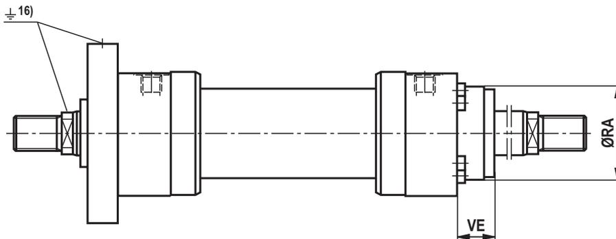
**Abmessungen: Rundflansch am Kopf CDH2...XC / CGH2...XC: MF3**
