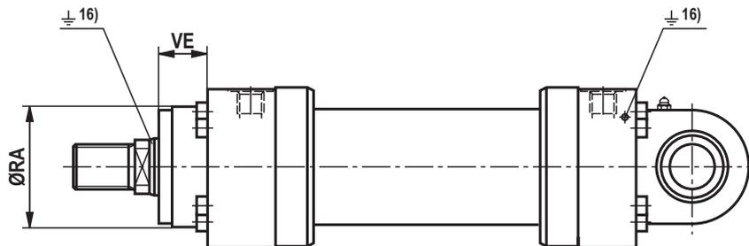
**Abmessungen: Schwenkauge am Boden CDH2...XC: MP3**
