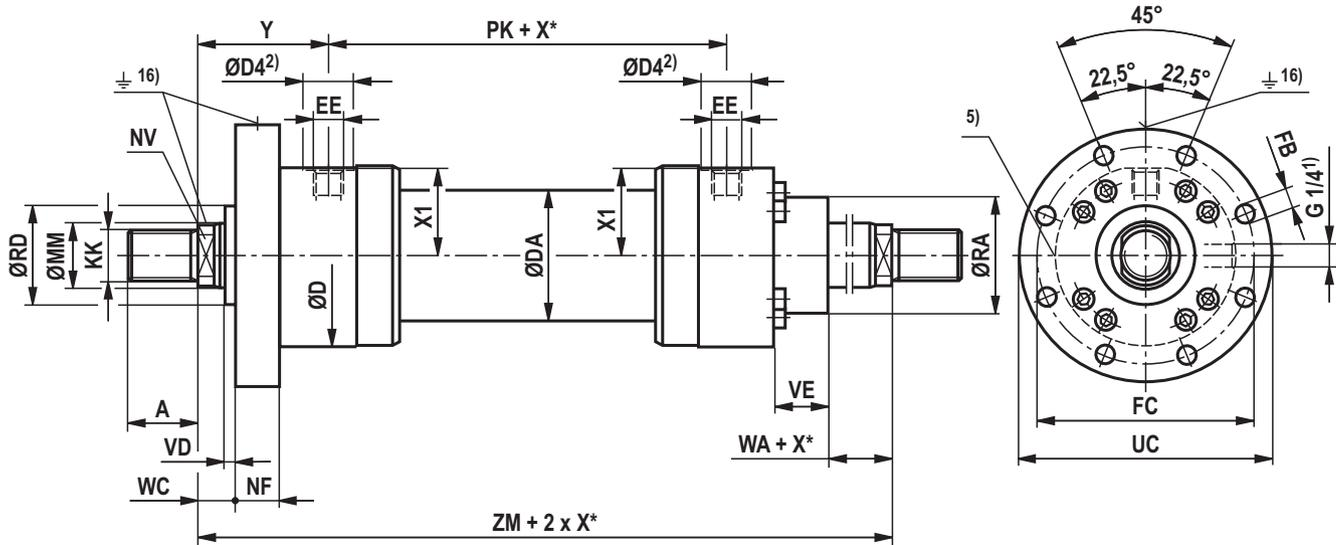
**CGH2...XC: MF3 <sup>10)</sup>: bei Dichtungsausführung „A“, „B“ und AL-Ø 160 ... 320 mm**
