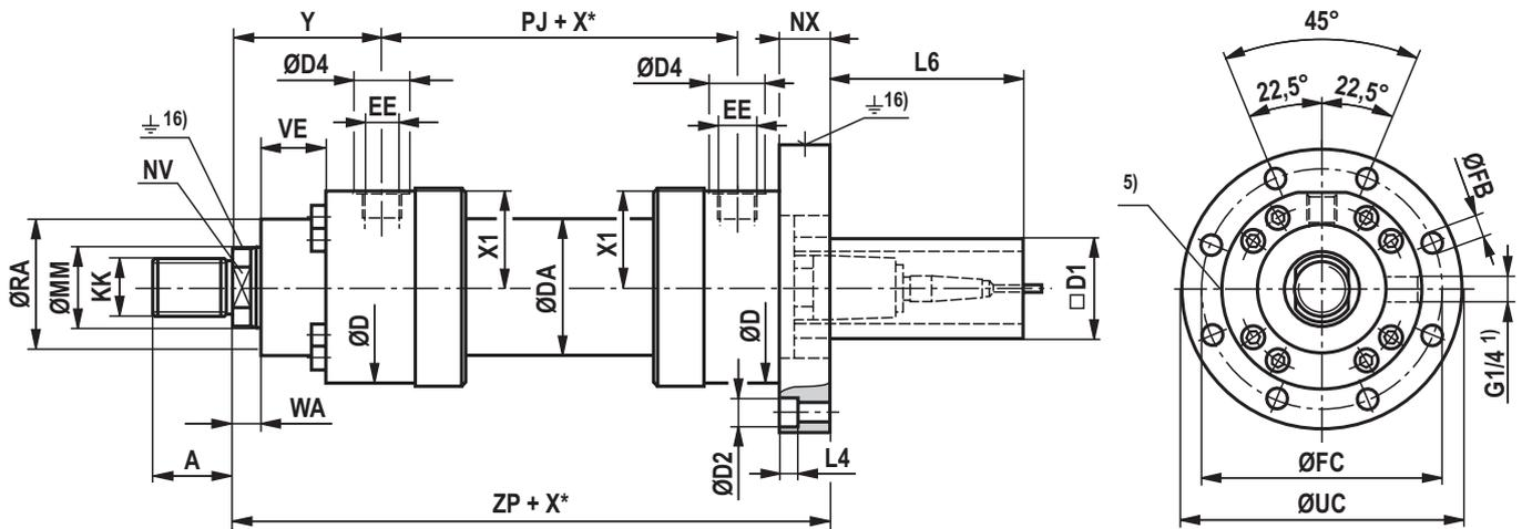
**Abmessungen: Rundflansch am Boden CSH2...XE: MF4**
