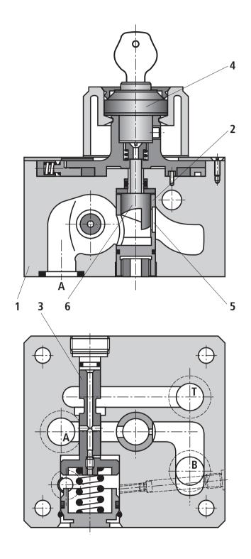
Das Stromventil Typ 3FRM ist ein 3-Wege-Stromregelventil. Es hat die Aufgabe, einen eingestellten Volumenstrom unabhängig von Druck- und Temperaturschwankungen konstant zu halten.
