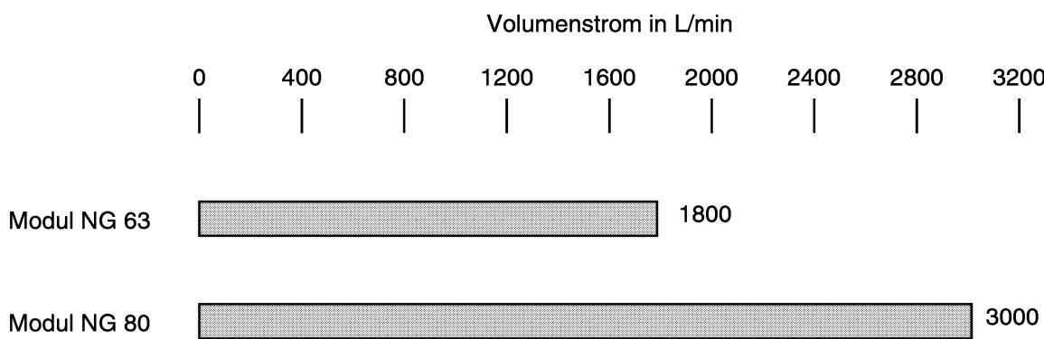
Maximal zulässiger Volumenstrom vom Ringraum des Zylinders zum Anschluß X2 nach T2 und von der Hydropumpe zum Anschluß P nach X1.
