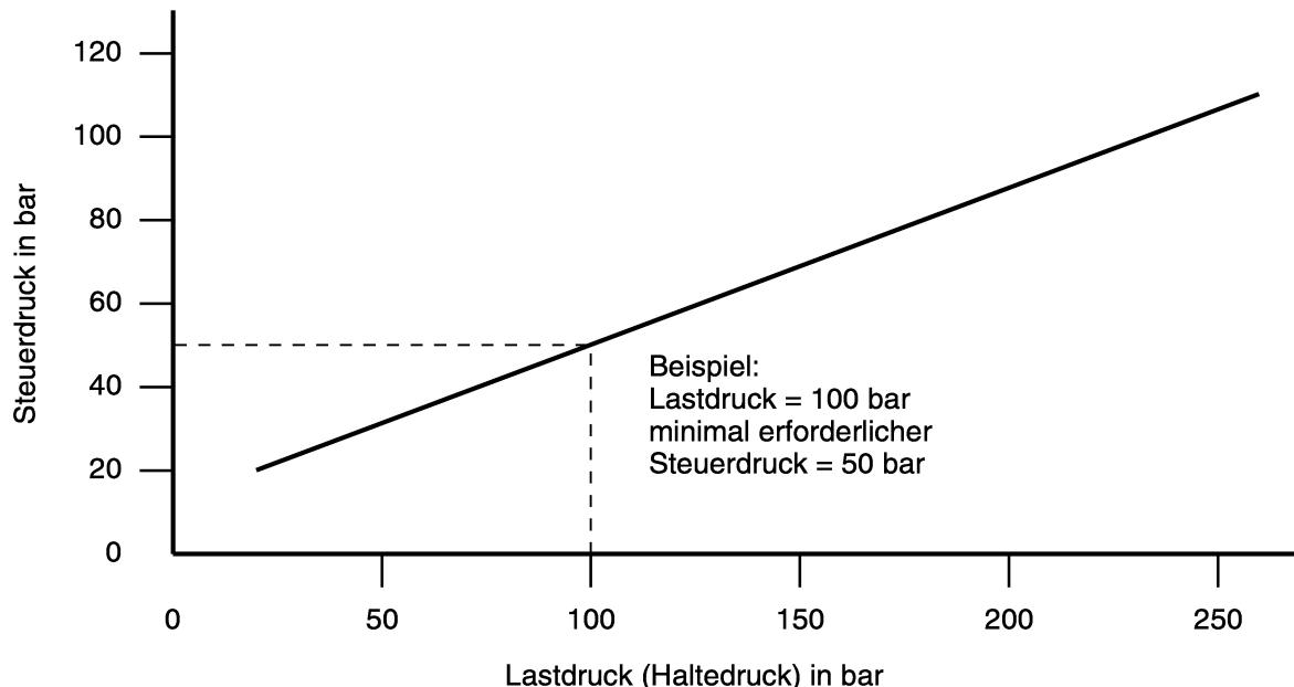
Erforderlicher Steuerdruck am Anschluß X im Verhältnis zum Lastdruck (Halte- druck) für die Ausführungsvarianten E1..., F1..., G1..., und H1... (siehe Ausführungsbeispiele Seiten 20 bis 23).
