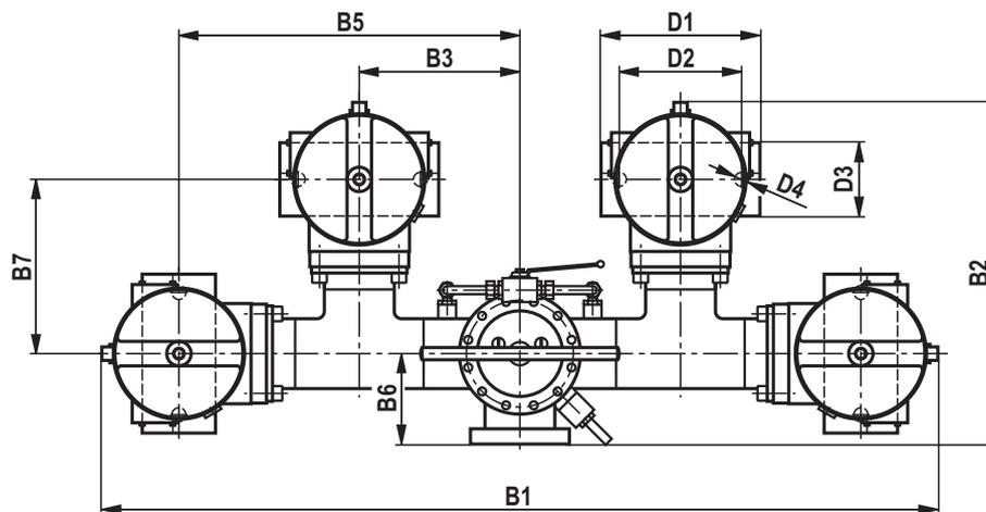
1) Ausbaumaß für Filterelementwechsel
